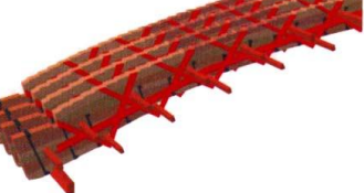
▲アーチを補強する鞍木と肋木
