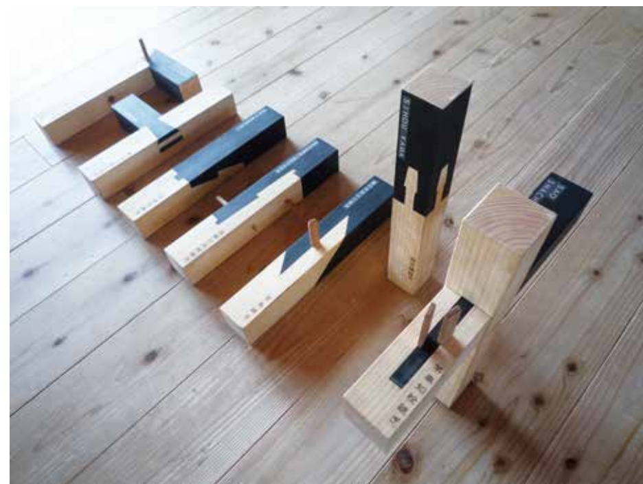
写真は継手(つぎて)と呼ばれる木材の接合部。梁や柱などを延長させるために、釘や金物を使わずに木材を組み合わせる。
